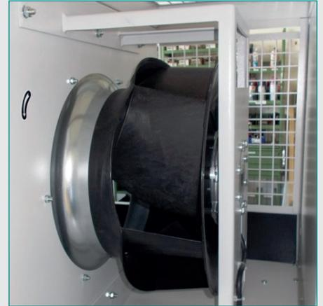
Des ventilateurs radial sont montés dans les compresseurs de la gamme RS-PRO D pour refroidir le compresseur. Les ventilateurs radial disposent d'une grande réserve de surpression et d'un bruit de marche agréable.
